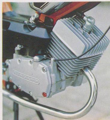
Herz dieses leicht zu handhabenden Fahrzeuges ist der 50-ccm-Block-Motor mit 2 Gängen und Pedalkickstart, Sproß einer neuen Mofa-Motorenfamilie, werkstattfreundlich durch horizontale Gehäuseteilung, millionenfach bewährte Ziehkeilkugelschaltung.
